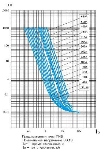
Рисунок 12. Времятоковые характеристики предохранителей ПН2 номинальным напряжением ~380В
