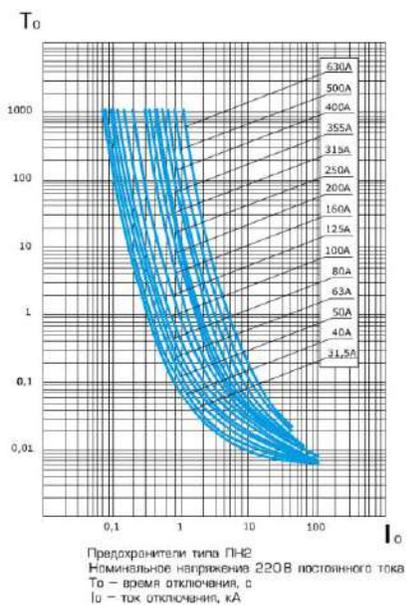
Рисунок 11. Времятоковые характеристики предохранителей ПН2 номинальным напряжением =220В
