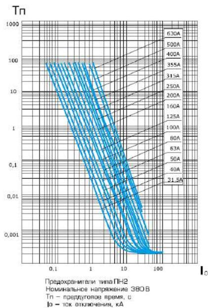
Рисунок 10. Времятоковые характеристики предохранителей ПН2 номинальным напряжением ~380В
