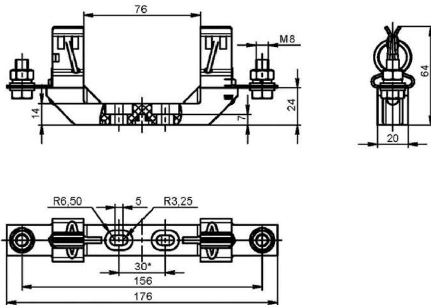
Рисунок 7. Держатель предохранителя ПН2-100
