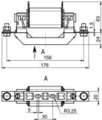
Рисунок 3. Предохранитель серии ПН2-100 для монтажа на собственном изоляционном основании
