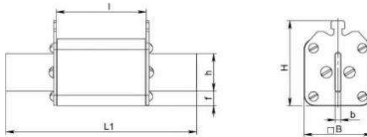
Рисунок 5. Габаритные, установочные размеры плавких вставок предохранителей ПН2
