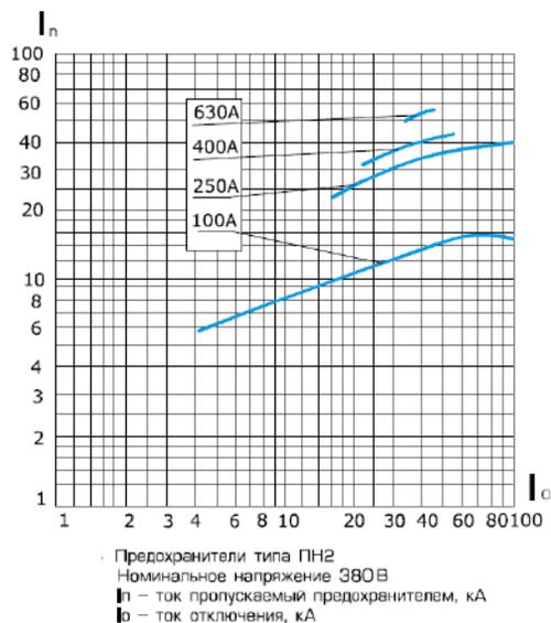
Рисунок 12. Характеристика пропускаемого тока
