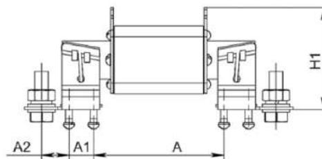
Рисунок 2. Предохранители серии ПН2 для монтажа на изоляционном основании комплектных устройств
