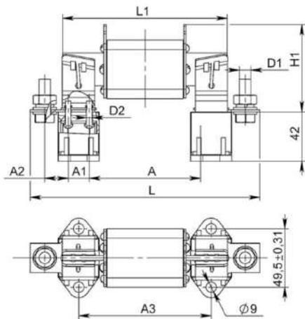
Рисунок 1. Предохранители серии ПН2 для монтажа на собственном изоляционном основании
