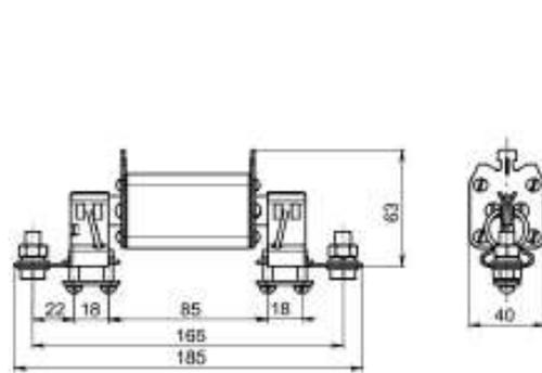
Рисунок 4. Предохранитель серии ПН2-100 для монтажа на изоляционном основании комплектных устройств
